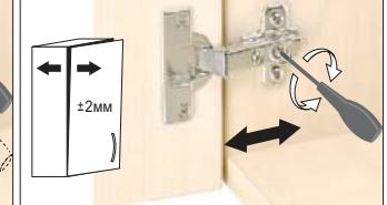
Ослабить крепежный винт и отрегулировать
