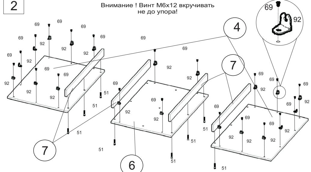
Во избежание потертостей деталей монтаж фурнитуры производить на любом предохранительном материале
