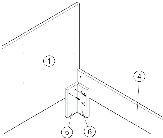
В изделии имеется четыре опоры, поэтому данный этап сборки производится четыре раза.
