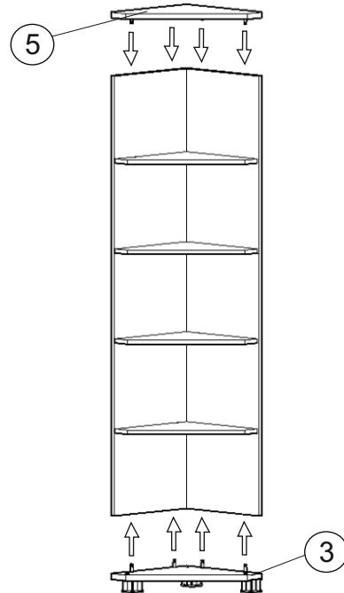
**6** После окончательной сборки и установки изделия на место, закрыть отверстия для регулировки опор заглушками 56. Во всех видимых местах в головку конфирмата 51 установить заглушку D13 56, в эксцентрик 53 установить заглушку D17 56.
