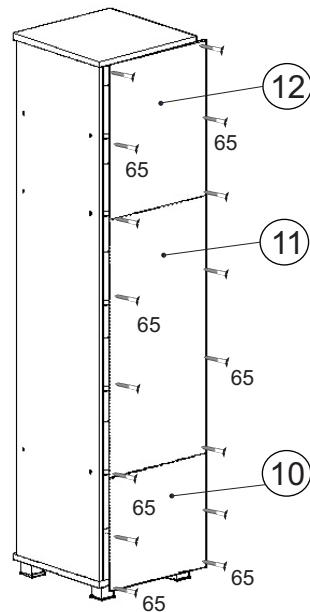
В местах соединения ДВП использовать скрепки для задней стенки 97.
